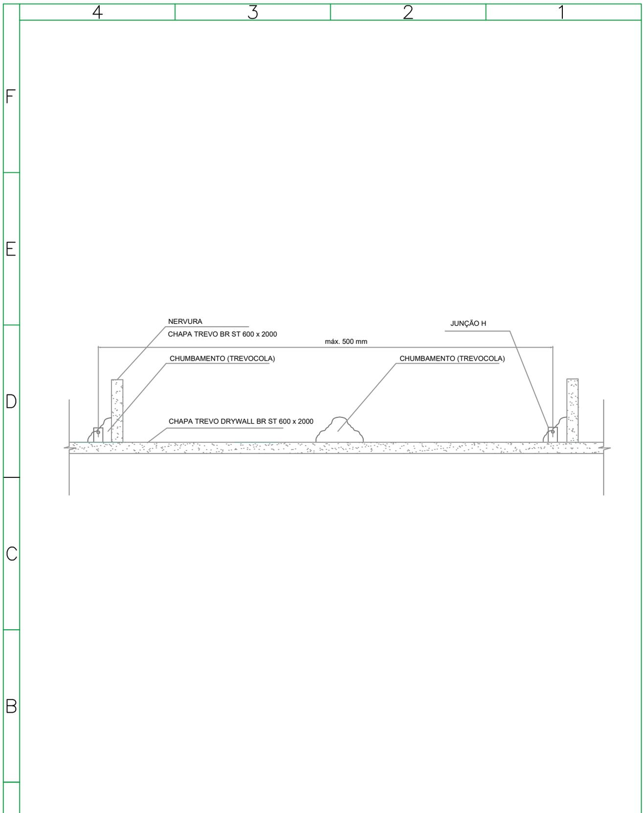
**DETALHE TÉCNICO:** FORRO TREVO ARAMADO - FTA - CORTE LONGITUDINAL
